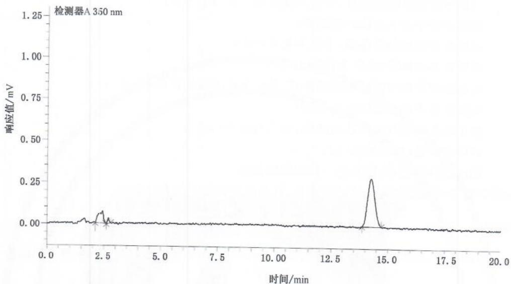
图 A.1 尼卡巴嗪标准溶液(0.1  $\mu\text{g/mL}$ )的高效液相色谱图
